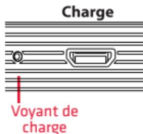
**La prise de charge** se connecte au câble fourni la prise de Charge USB pour brancher le haut-parleur dans une source d'alimentation ou un adaptateur.
