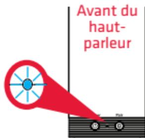
Si votre téléphone ou tout autre appareil Bluetooth a été apparié antérieurement au haut-parleur, celui-ci, lorsqu'il est allumé, essaie automatiquement de se reconnecter à cet appareil. S'il faut appairer un nouvel appareil, appuyer sur le bouton **Pair** sur le côté du haut-parleur et jusqu'à ce que le haut parleur émette un signal sonore et que voyant d'appariement DEL commence à clignoter.
